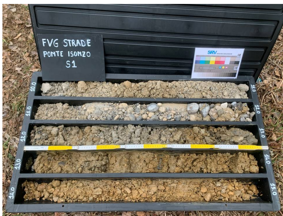
Foto n° 4: Sondaggio S1, Cassetta 3: 10.0-15.0 metri.
