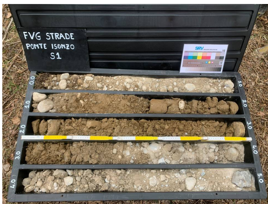
Foto n° 2: Sondaggio S1, Cassetta 1: 0.0-5.0 metri.
