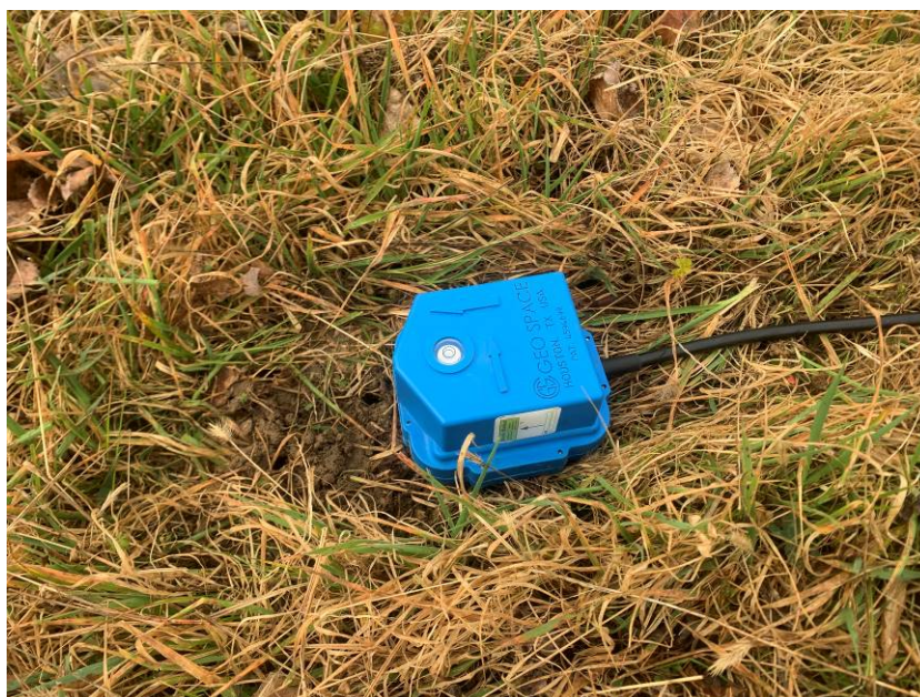
Foto n° 8: Stazione di sismica passiva HVSR_1.
