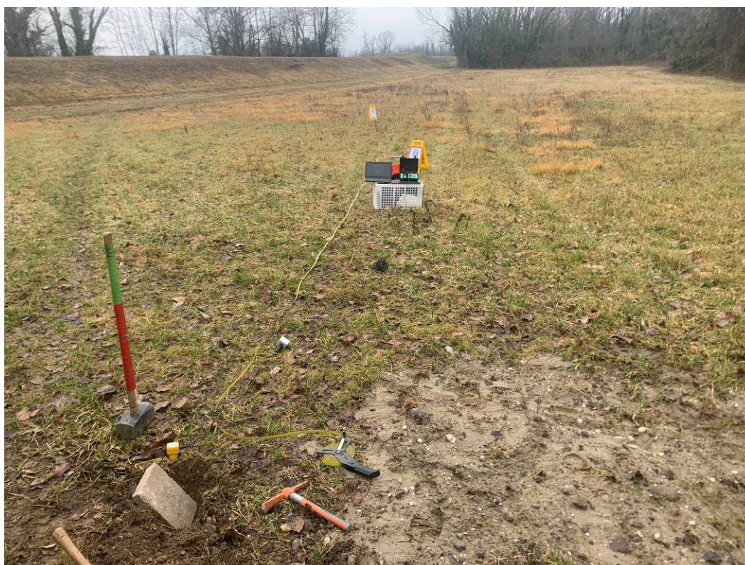
Foto n° 9: Stendimento sismico con acquisizione MASW 1 (componente THF).
