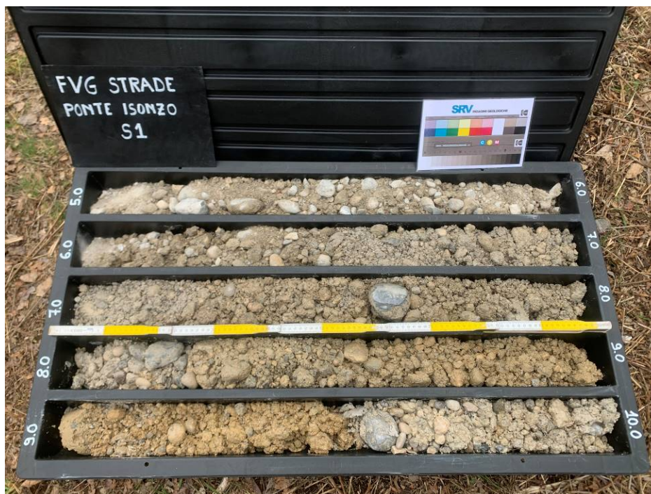
Foto n° 3: Sondaggio S1, Cassetta 2: 5.0-10.0 metri.
