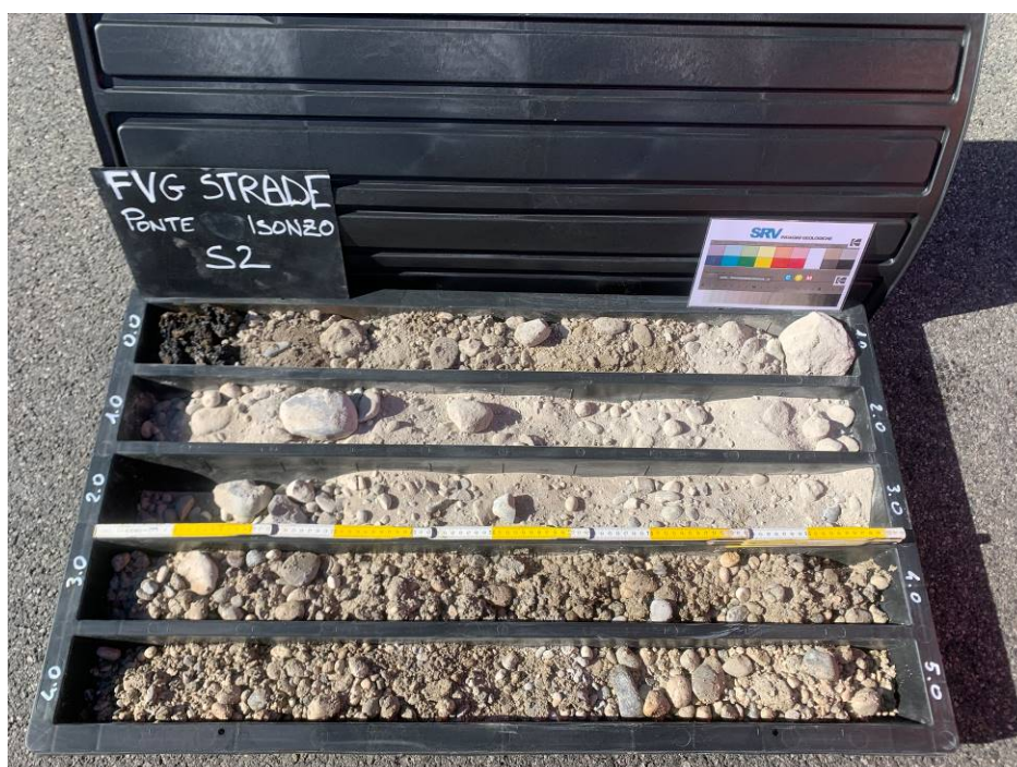
Foto n° 6: Sondaggio S2, Cassetta 1: 0.0-5.0 metri.
