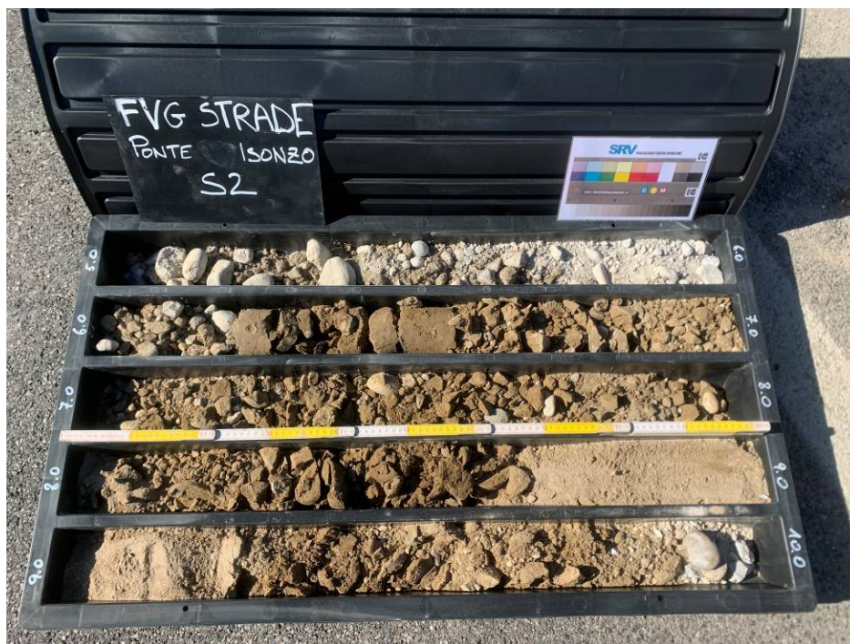
Foto n° 7: Sondaggio S2, Cassetta 2: 5.0-10.0 metri.
